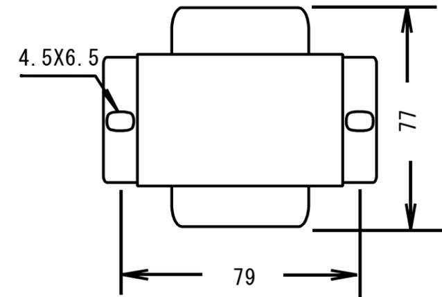
概略外形寸法 91x77x81(H) 黒色塗装縦型バンド型 1.3Kg
